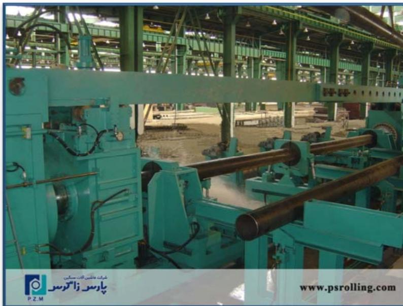
۴- ماشین هیدرو تست لوله (Pipe Hydro-Testing Machine)
