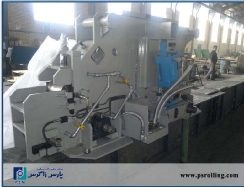
۴- میز قالب (Oscillating Bench)
