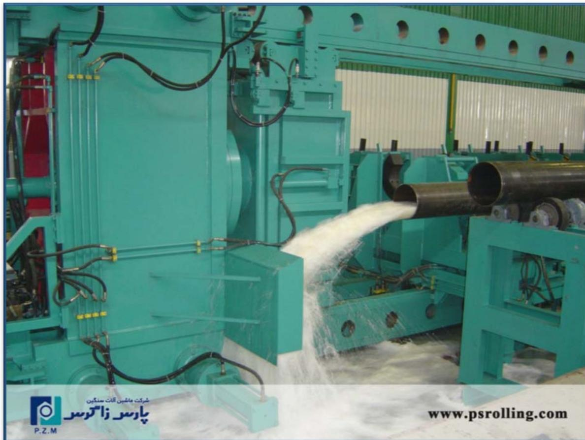
۳- ماشین هیدرو تست (لوله Pipe Hydro-Testing Machine)
