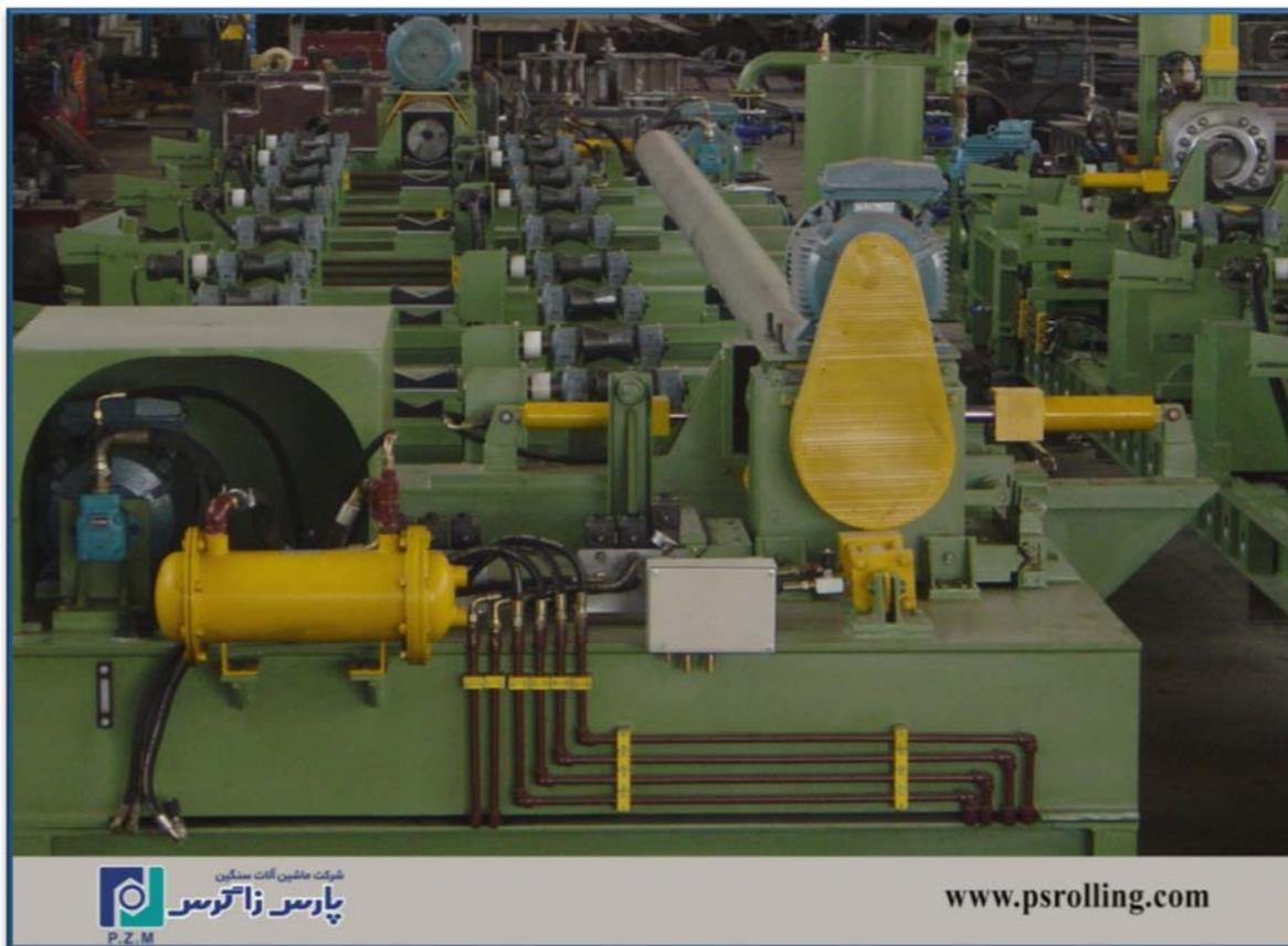
۳- ماشین پلیسه گیر لوله (Pipe End Facing Machine)
