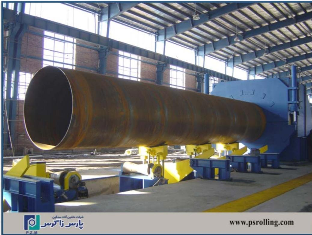
۵- ماشین پلیسه گیر لوله (Pipe End Facing Machine)
