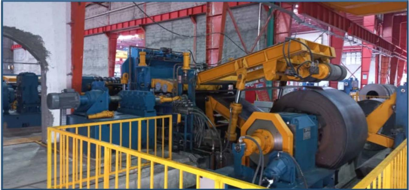
**B. خطوط تولید لوله های درز جوش ( ERW Steel Tube Mill )**
